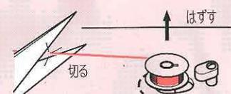
糸を切り、糸巻き軸を戻してからポピンをはずします。
