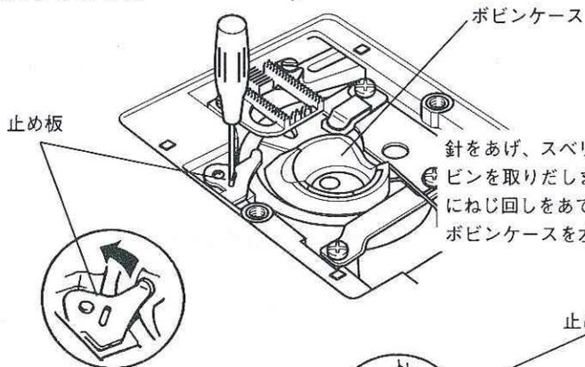
針をあげ、スベリ板をひらき、針板をはずし、ボビンを取りだします。ボビンケース止め板のみぞにねじ回しをあてて止め板を矢印の方向にねじり、ボビンケースを左にねじって取り出します。
