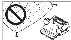
7.使用の手びきに記載のあるミシンのお手入れを行うときは、電源スイッチを切り、電源プラグを引き抜いてください。
