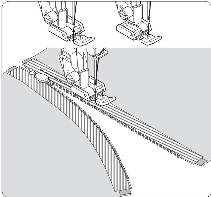
ファスナーの右側を縫うときは、押えホルダーを押えの左側のピンに取付けて縫います。
