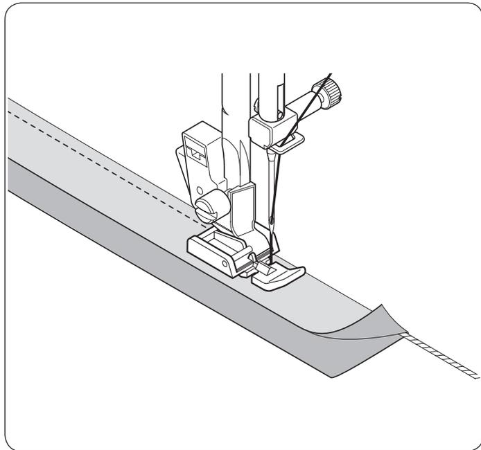
バイアステープを外表に折るか、バイアステープでコードをくるみ、押えホルダーをファスナー押えの右側に取付けて図のように縫います。
