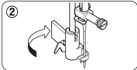
② 図のように糸通しカギが針穴に入る方向に回転させてください。
