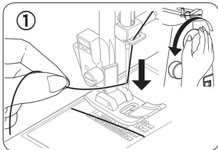
① 押え上げレバーを上げてください。針糸を軽く左手で持ち、プリーを手前に完全に一回転させてください。
