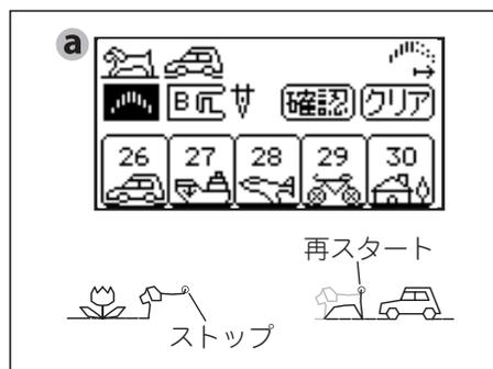
**b** ぬいをストップして押えを上げると、マークが (🌀) に変わります。この場合、再スタートさせると、中断した模様・文字の最初からぬい始めます。これは、糸切れした場合などで模様・文字をぬい直すための機能です。糸切れした模様・文字をほどいて、その最初の位置に布を合わせてからぬい直してください。
